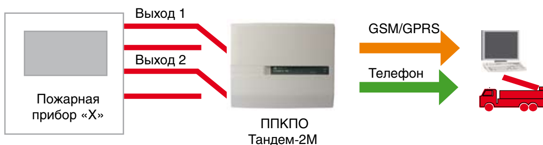
Рис.14. Пример подключения объектового оборудования к ППКОП «Тандем-2М»
