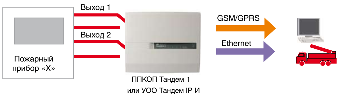
Рис.19. Пример подключения посредством релейных выходов
