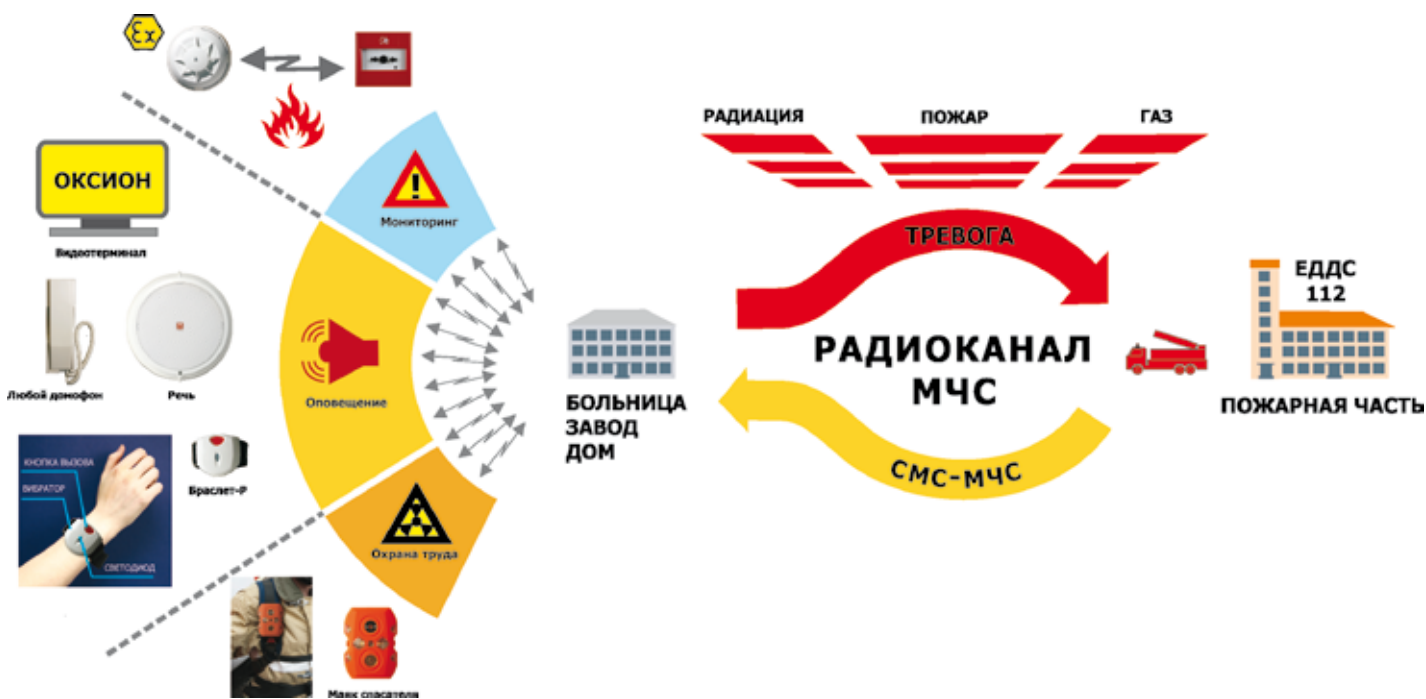
Рис.2. Структурная схема комплекса «Радиоволна»
