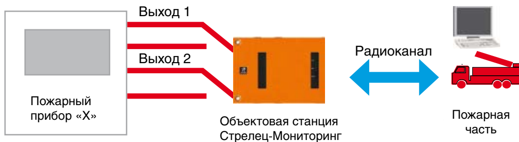
Рис.12. Пример подключения посредством релейных выходов
