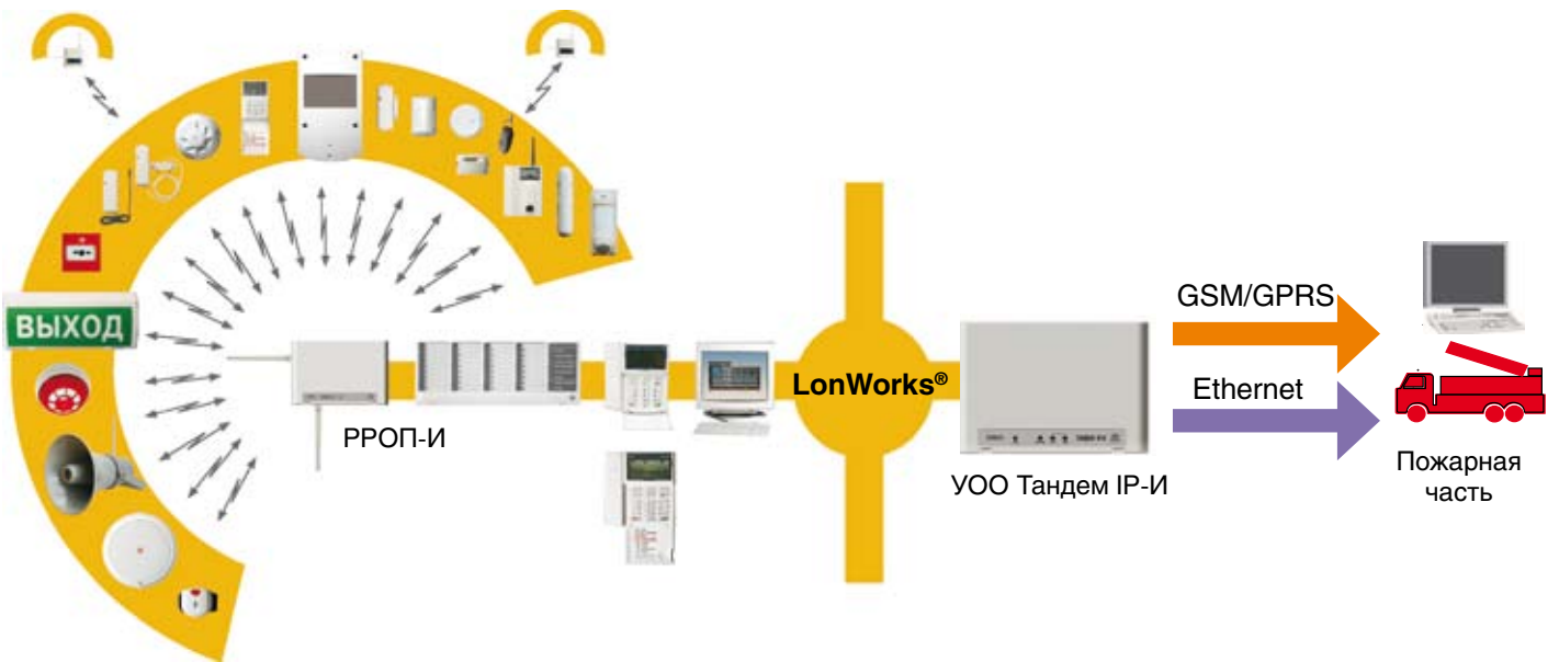
Рис.18. Пример подключения по протоколу LON (ИСБ «Стрелец-Интеграл»)
